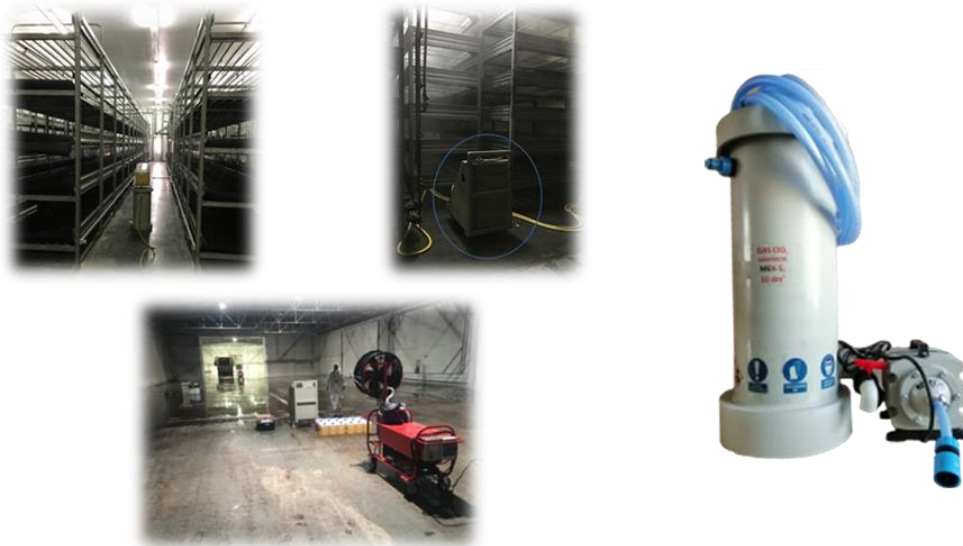
Rysunek 2. Zdjęcia przedstawiające dezynfekcję gazowym ClO 2 w hali uprawowej, hali dezynfekcji skrzyń IV fazy i w hali zasiewów grzybni oraz generatory gazowego ClO 2 .
