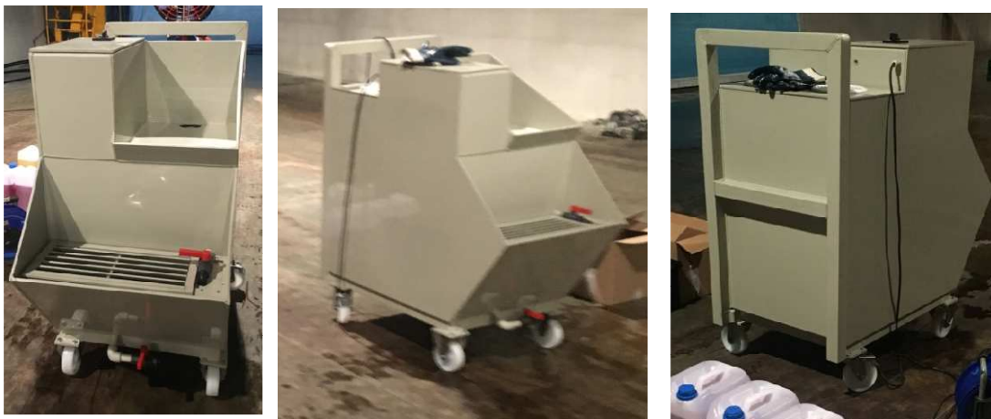
Rys.2. Widok zewnętrzny GENERATORA gazowego ClO 2 , MEX-4.
